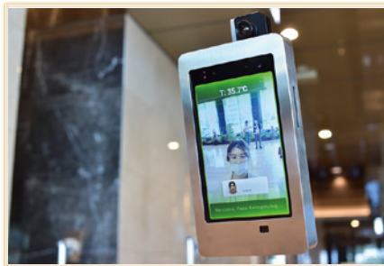
温度検知が可能な顔認証入退館システム
