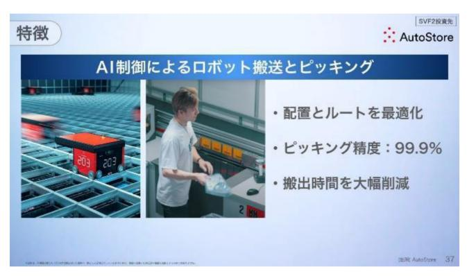
全部 AI で分析して、出荷頻度の高い品目ほど、ロボットに近い上の方の棚に置いて、全部 AI で分析した形で、場所の移動とかロボットの移動を最適化しているということです。
