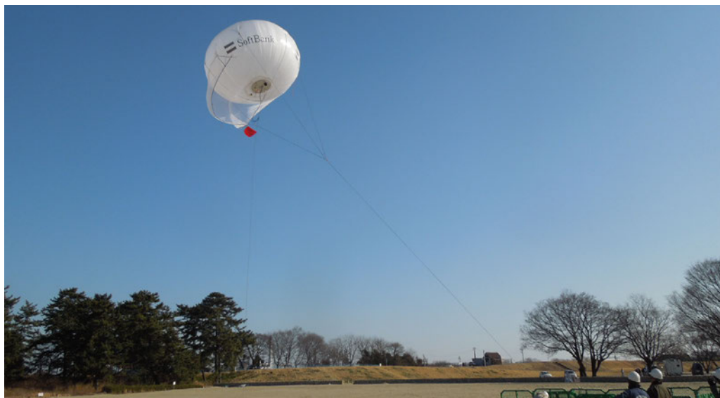
係留気球を利用した臨時無線中継システムの実証実験の様子
